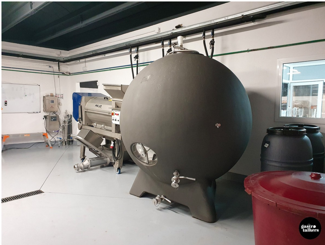
Tina de formigó. Foto: Albert Ribas.
