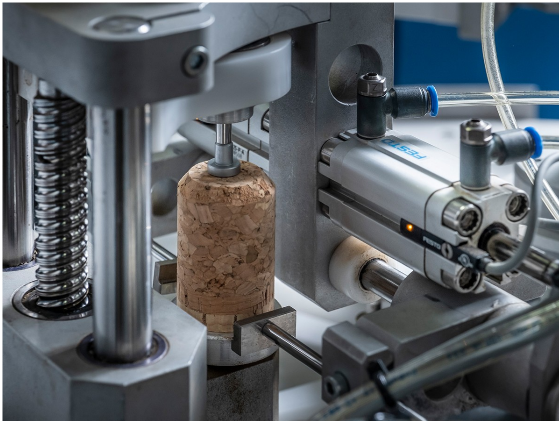
Fabricació d'un tap de suro. Foto: AECORK.
